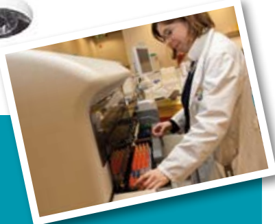
Chaque analyseur est capable de mesurer une vingtaine de paramètres sur un seul échantillon.
